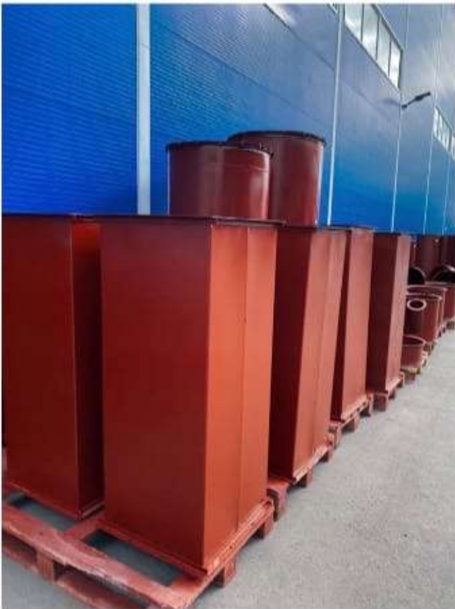
Воздуховоды из черной холоднокатаной стали
