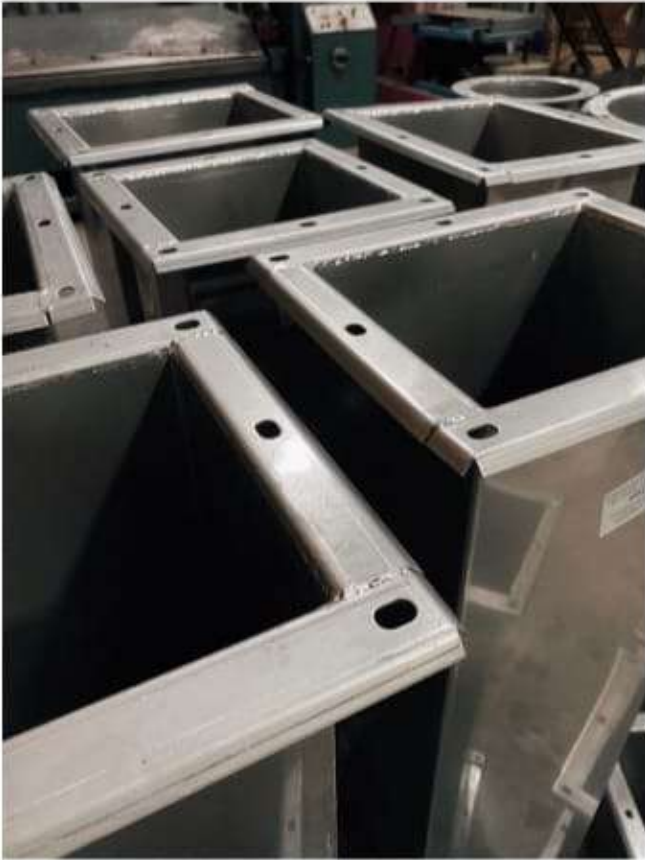
Воздуховоды из нержавеющей стали
