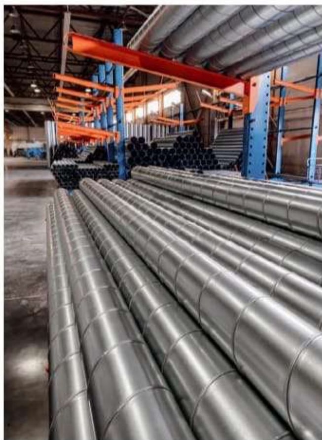
Воздуховоды спирально-навивные круглого сечения
