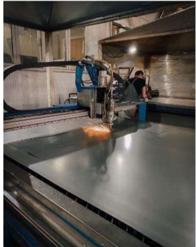
Станки лазерной и плазменной резки в производственном цехе ПК Титан, процесс лазерной резки листового металла
